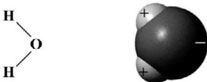
*Der  $105^\circ$ -Winkel zwischen den beiden Molekülorbitalen und die unterschiedliche Elektronegativität von H und O bewirken den Dipolcharakter der Wassermoleküls: Wasserstoffseitig der positive, am Sauerstoffatom der negative Pol.*
